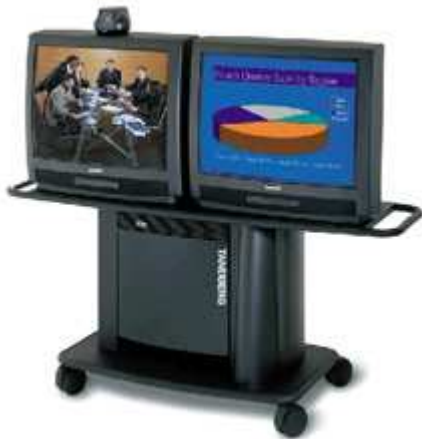
Sistema de videoconferência dedicado para salas de reunião,, com console, monitores de TV e câmara PTZ (Tandberg)
